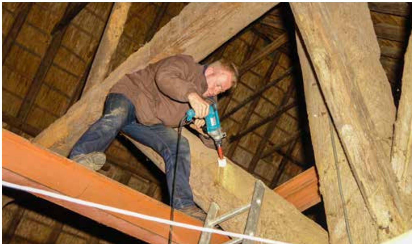
Dendrochronologisch onderzoek, het boren van een monster ten behoeve van de analyse van de jaarringen van een balk, op grond waarvan het kapjaar van de boom kan worden vastgesteld.
