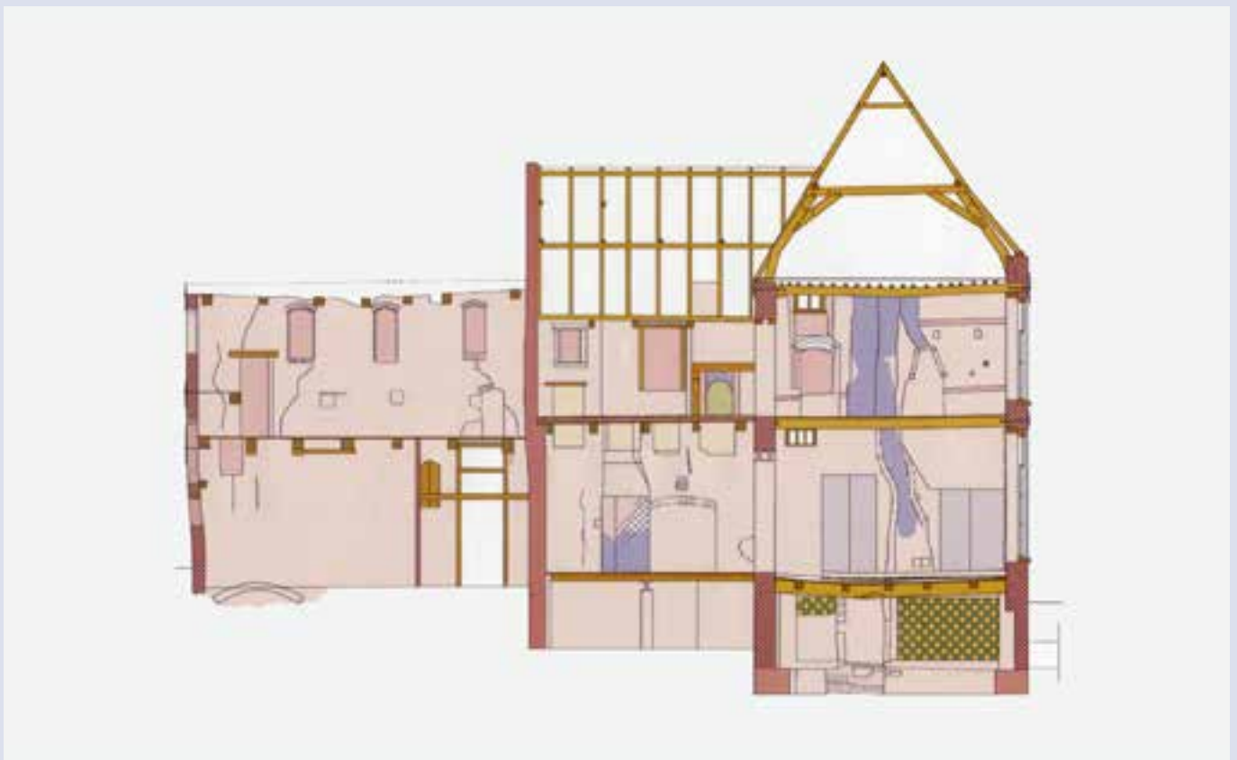
Bouwhistorisch onderzoek, Gelkingestraat 48, tekening bouwsporen, met rechts de doorsnede over het 14 e -eeuwse dwarshuis, met onder de kelder het fundament van een nog oudere kelder met tufstenen gewelfaanzetten.
